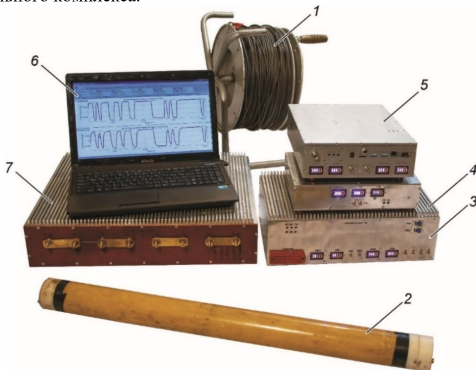
Рисунок 4.1. Экспериментальный образец измерительного комплекса ЭРК ШПС, внешний вид: 1 – индукционная зондирующая рамка (ИЗР); 2 – индукционный датчик сигналов (ИДС); 3 – генератор зондирующих сигналов (ГЗС); 4 – устройство градуировки (УГ); 5 – блок управления и регистрации сигналов (БУРС); 6 – переносной компьютер (ПК); 7 – блок ограничения тока (БОТ) (выполнено автором)
